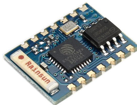
Рис.1 Внешний вид устройства Размер платы 21x17мм
